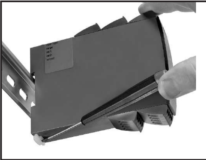
Илл. 1: Модуль отсоединяют от рейки DIN, опуская нижний замок.
